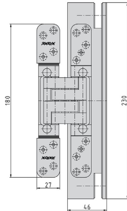
**Primjena:** za staklena vrata, držač panta osigurava sigurno pričvršćivanje na krila vrata; kada su vrata zatvorena pant je **nevidljiv**
