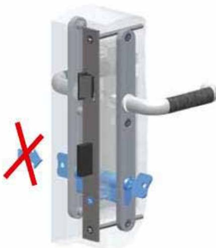
Ključ ne smije ostati unutra u položaju rotacije. U takvom slučaju, cilindar se neće moći zaključati s vanjske strane.
