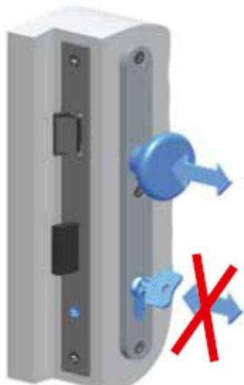
Vrata NIKADA ne otvarati ili zatvarati povlačenjem ključa. Ova radnja može prouzročiti teška oštećenja ključa ili cilindra, čime se ugrožava njihova funkcija zaključavanja. Za zatvaranje ili otvaranje koristiti samo kvaku ili gumb na vratima.
