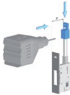
Treibriegelstange mit parallel zum Stulp aufgestelltem Verbindungselement durchbohren (Bohrer  $\varnothing$  2,5 mm).
