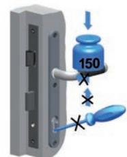
Der Drücker darf nur im normalen Drehsinn belastet werden. In Betätigungsrichtung darf auf den Drücker maximal nur eine Kraft von 150N aufgebracht werden. Das Schloss darf nur mit dazugehörigem Schlüssel und nicht mit artfremden Gegenständen geschlossen werden.
