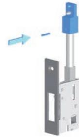
Treibriegelstange und Verbindungselement mit Spannhülse  $\varnothing$  2,5 mm x 16 mm verbinden.
